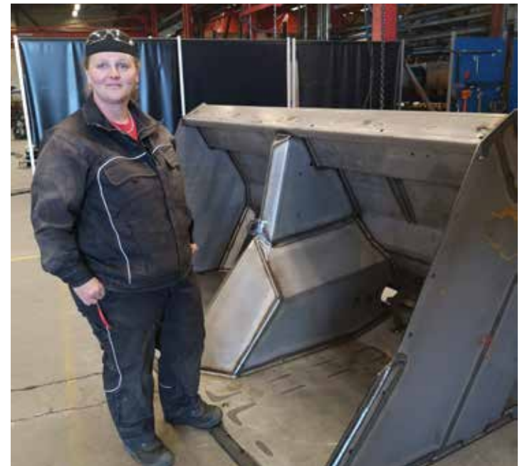
Cecilie viser meg de store strøkassene hun nettopp har sveiset ferdig, der en del av prosessen er fortsatt manuell.
