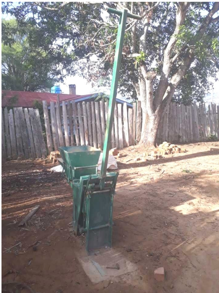
Med denne maskinen blir murstein i høy kvalitet laget.
