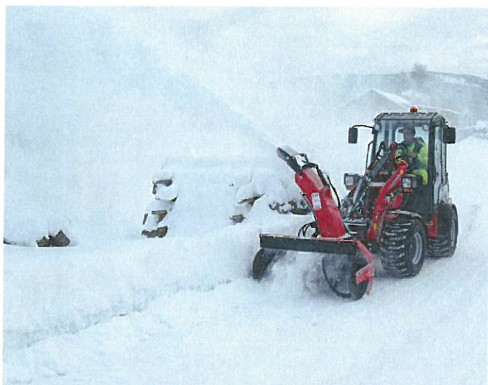
Tokvam to-trinns snøfres, ferdig tilpasset maskinen B= 1,5 m
