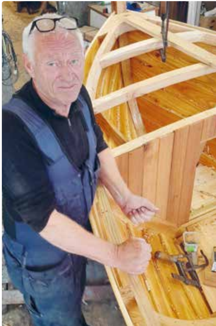
S kroget har nettopp fått et strøk med olje. Snart skal dollbordet på.
